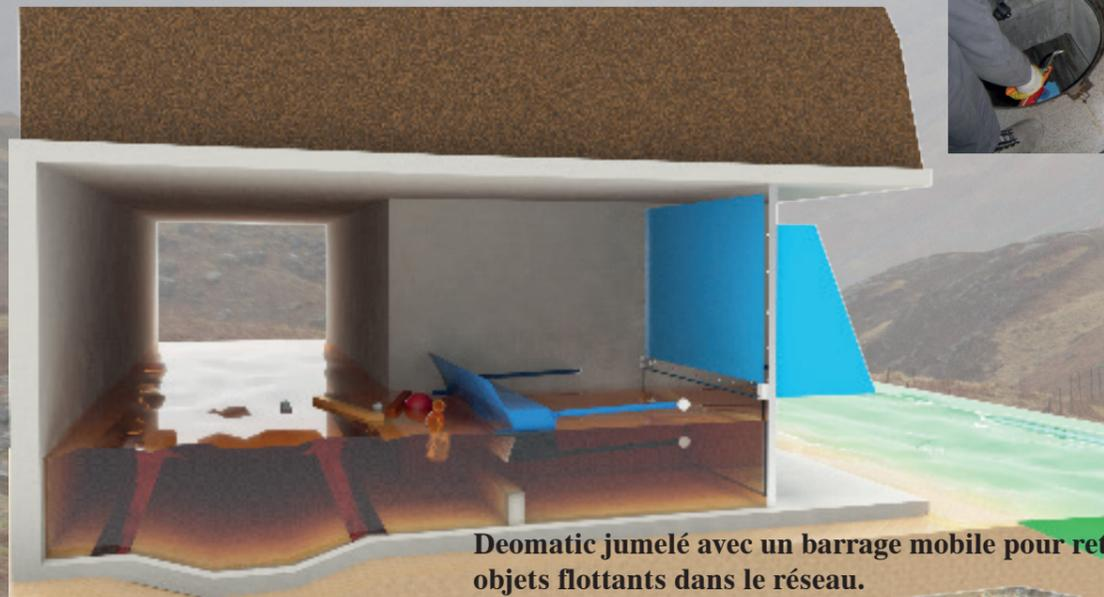
Deomatic jumelé avec un barrage mobile pour retenir les objets flottants dans le réseau.
